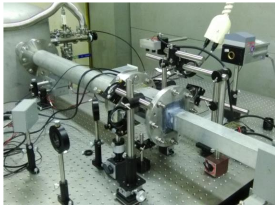
図5 極超音速衝撃波管に適用したマッハツェンダー干渉法
